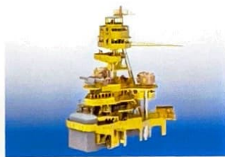
上层建筑 Superstructure
